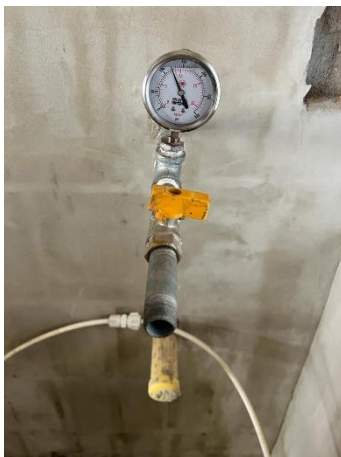
Ilustración 16, Prueba de agua cargada a 120 PSI, Fuente: Autoría propia.
