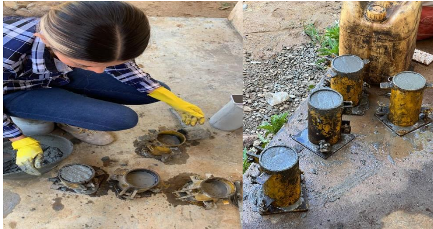
Ilustración 13, Toma de muestras de pega de mortero, Fuente : Autoría propia.
