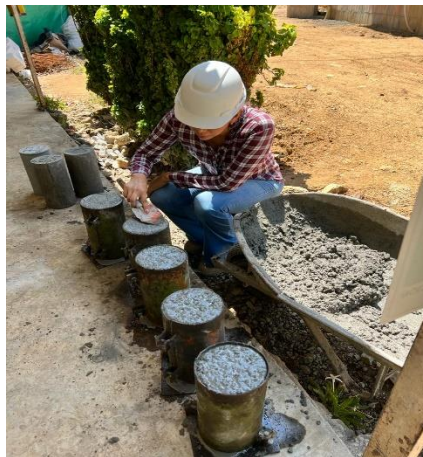
Ilustración 6, Toma de muestras de concreto, Fuente: Autoría propia.
